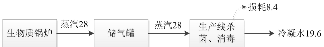
图 2-1 厂区蒸汽平衡图 (t/d)
