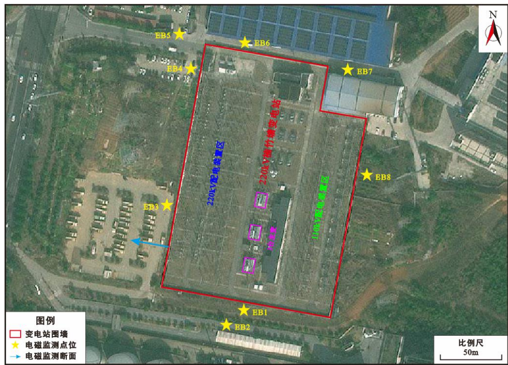
图 2 220kV 楠竹塘变电站监测布点示意图
