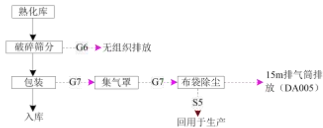
图 2-8 过磷酸钙生产工艺流程及产污节点图
