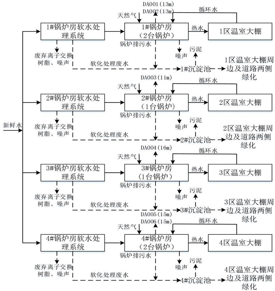
图 2-3 核心区热水锅炉工艺流程及产污节点图
