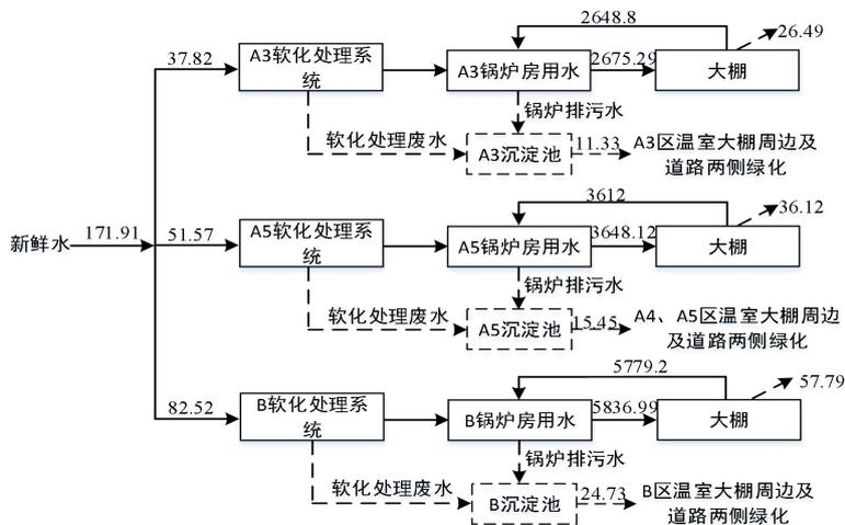
图 2-2 辐射带动区锅炉房水平衡图 m<sup>3</sup>/d
