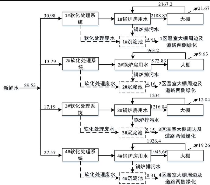
图 2-1 核心区锅炉房水平衡图 m<sup>3</sup>/d
