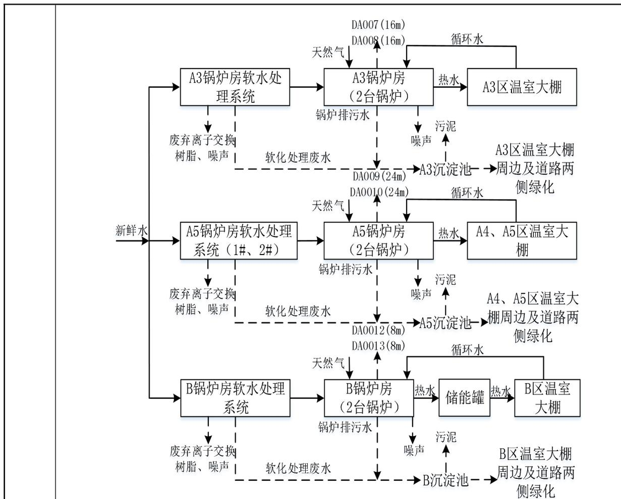
图 2-4 辐射带动区热水锅炉工艺流程及产污节点图
