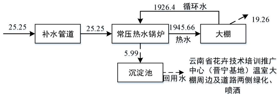
图 2-1 项目水平衡图 m<sup>3</sup>/d
