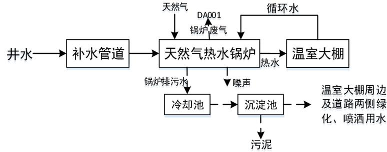
图 2-2 项目热水锅炉工艺流程及产污节点图
