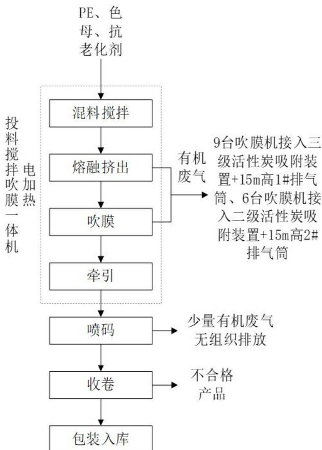
图 2.2-3 原有在建项目②农用膜生产工艺流程图
