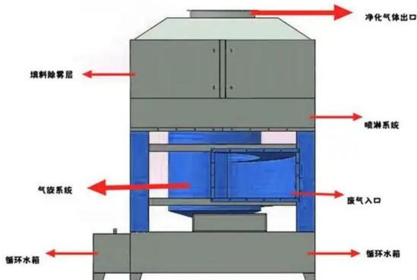
图 6.2.1-1 喷淋塔结构示意图
