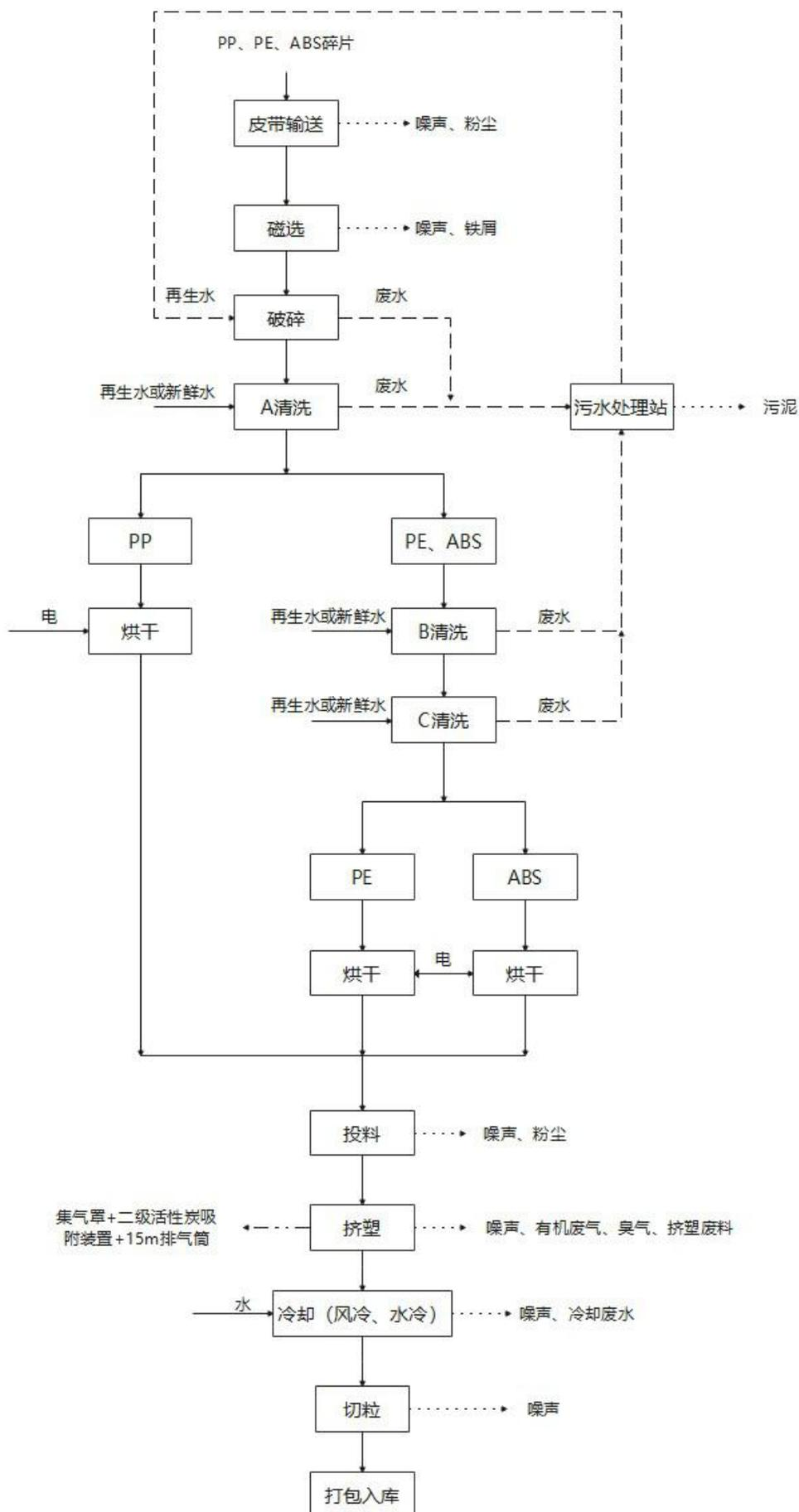
图 2.2-2 原有在建项目①生产工艺流程图
