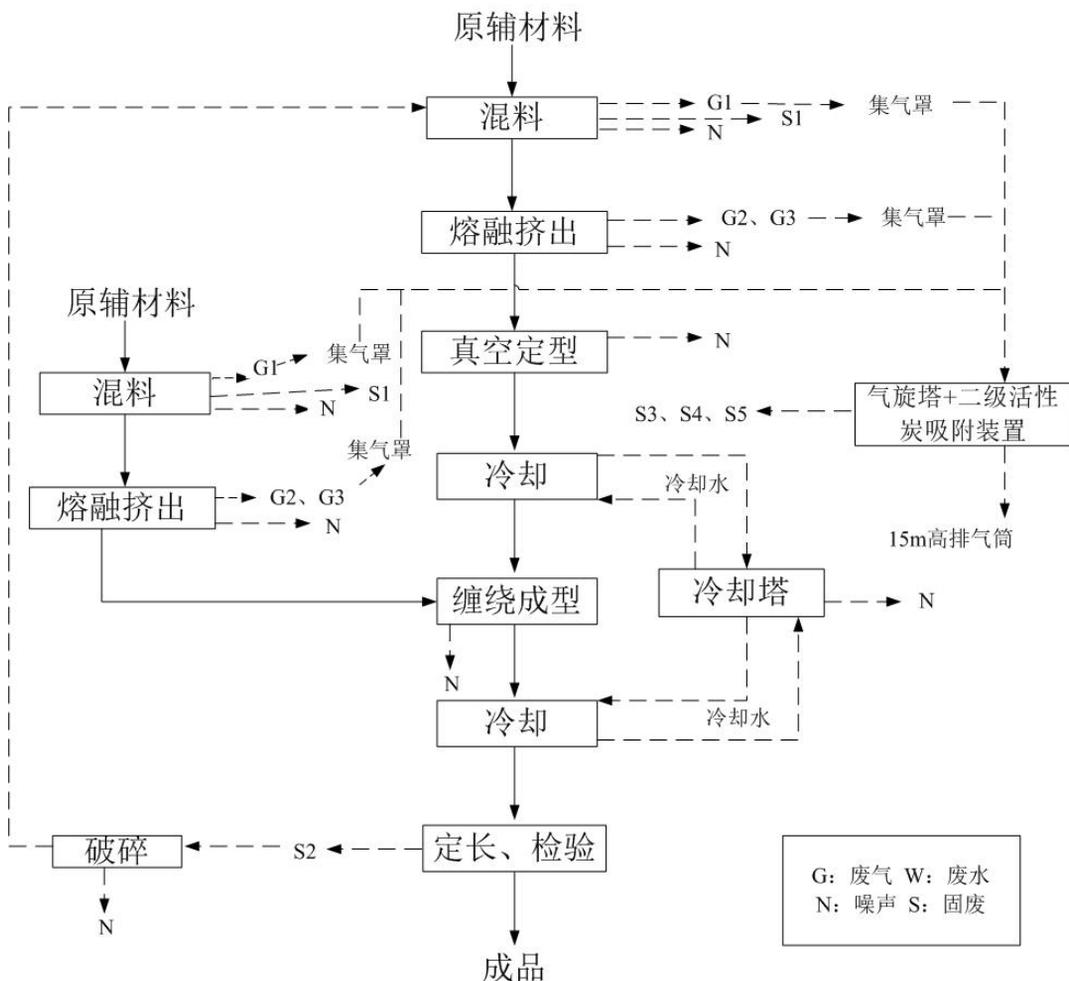
图 3.2.1-2 HDPE 缠绕管生产工艺流程及产污节点图
