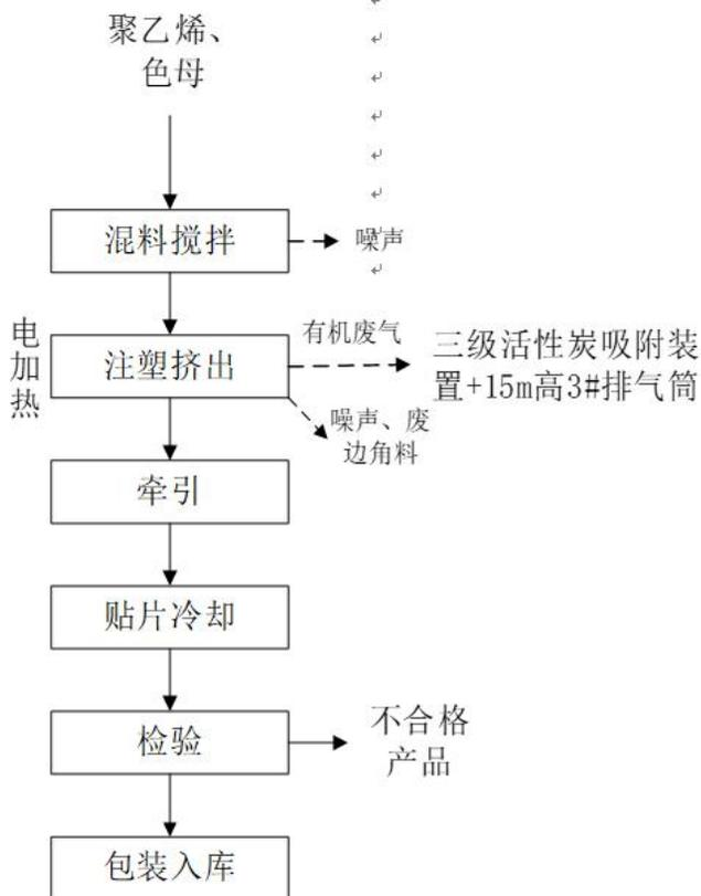
图 2.2-4 原有在建项目②滴灌带生产工艺流程图
