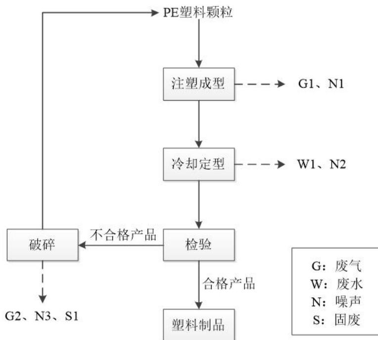
图 2.2-1 原有已建项目生产工艺流程图
