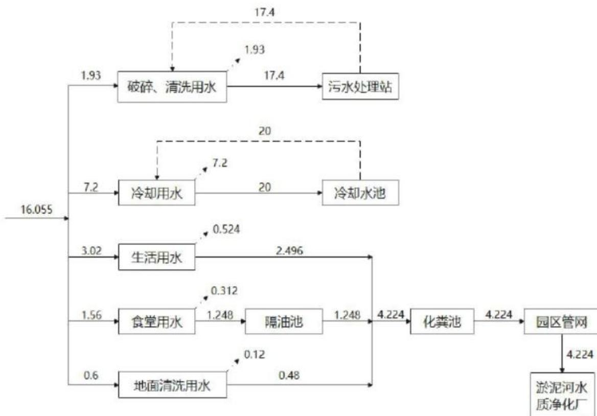
图 2.1-2 原有在建项目①水平衡图 (单位:  $m^3/d$ )
