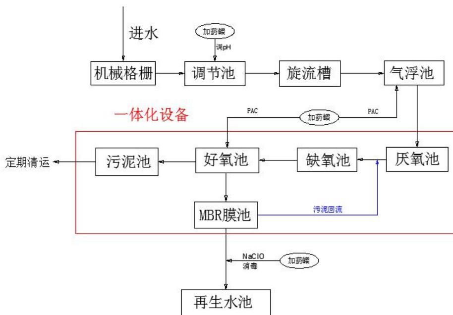
图2.4.2-1 原有在建项目①清洗废水处理工艺流程图
