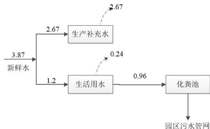
图 2.1-1 原有已建项目水平衡图 (单位: m<sup>3</sup>/d)
