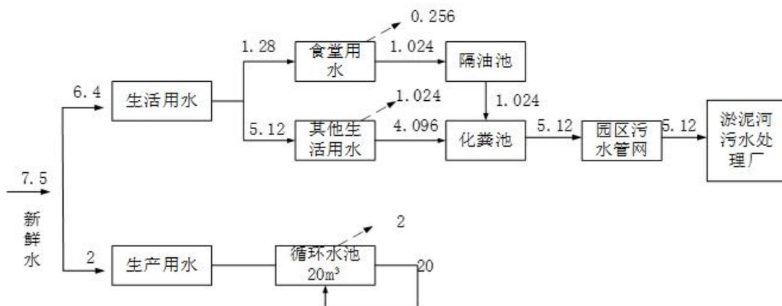
图 2.1-3 原有在建项目②水平衡图 (单位:  $m^3/d$ )
