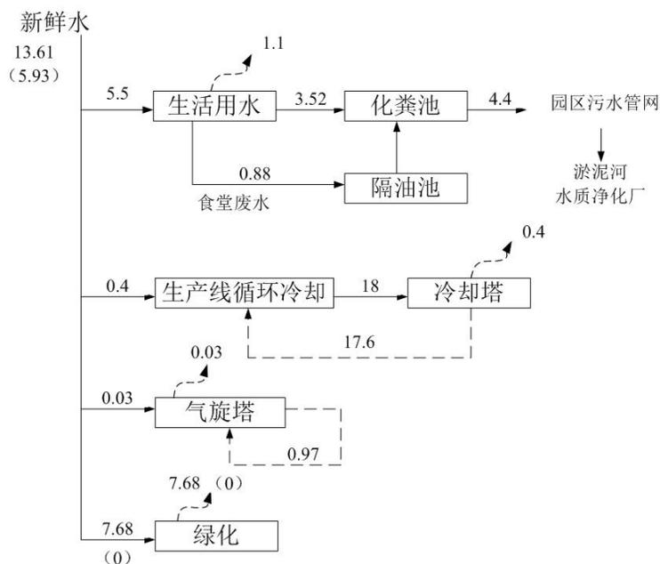
图 3.2.1-3 本项目水平衡图 (括号代表雨天) 单位: m<sup>3</sup>/d
