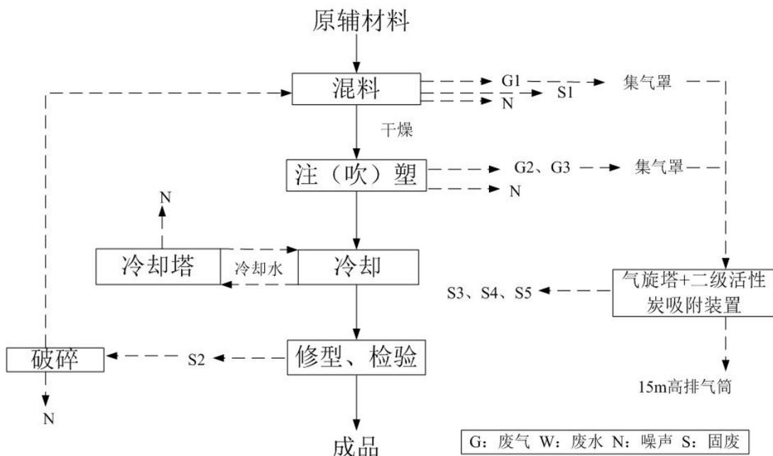
图 3.2.1-1 塑料检查井、塑料托盘、塑料垃圾桶生产工艺流程及产污节点图
