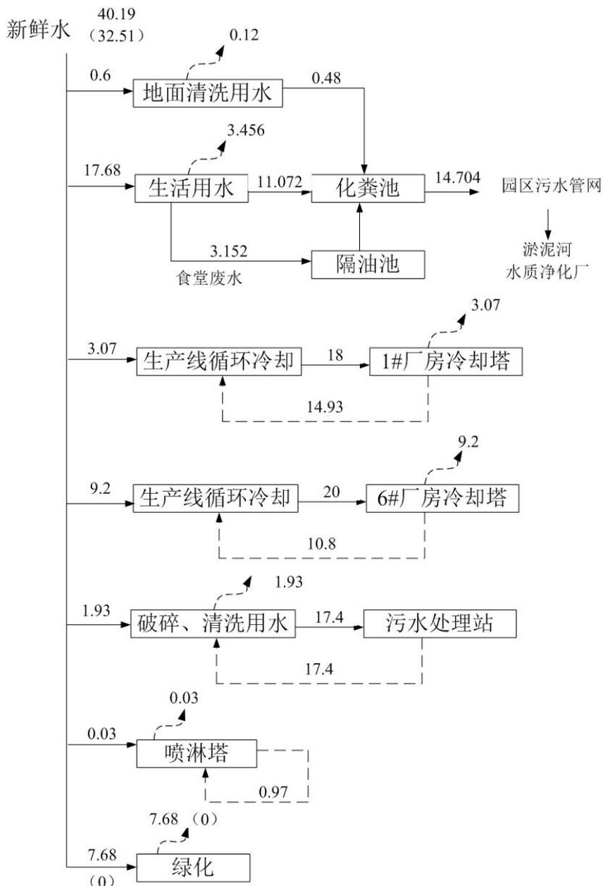
图 3.2.1-4 本项目建成后全厂水平衡图 (括号代表雨天) 单位:  $\text{m}^3/\text{d}$
