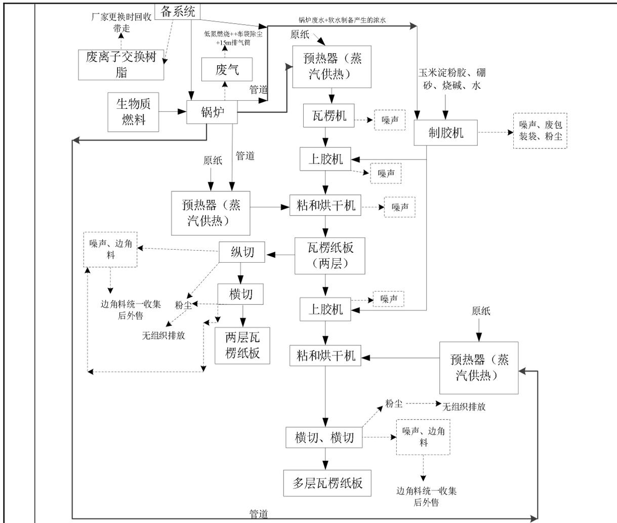
图 2-2 瓦楞纸板生产工艺流程及产污节点图
