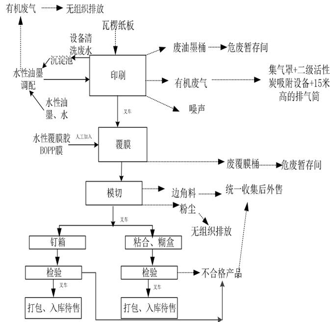
图 2-5 覆膜瓦楞纸箱生产工艺及产污节点图
