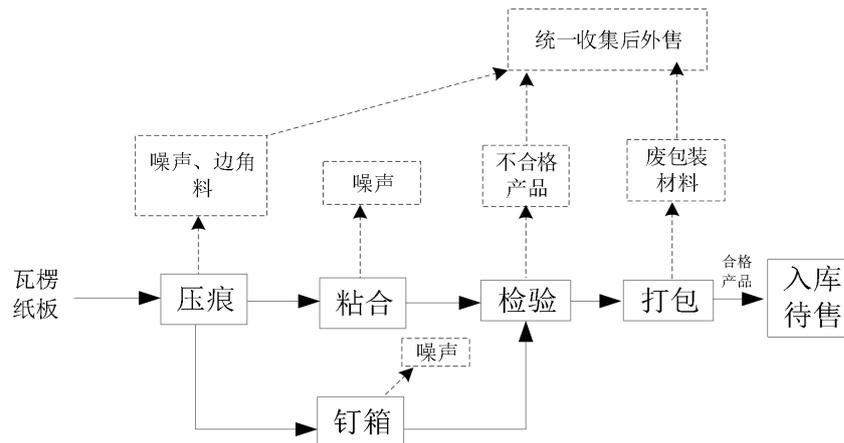
图2-3 普通瓦楞纸箱生产工艺流程及产污节点图
