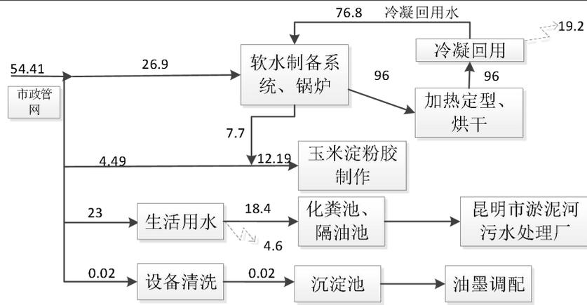
图 2-1 本项目水平衡图 (m<sup>3</sup>/d)
