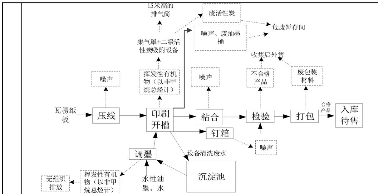
图2-4 彩色瓦楞纸箱生产工艺流程及产污节点图
